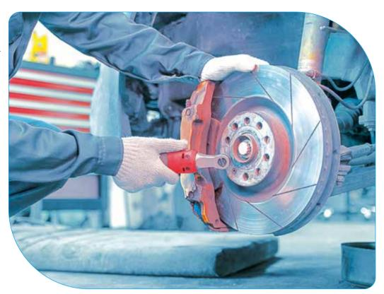
frenado, normalmente es porque en el momento del cambio no se sustituyeron las láminas antirruido, o los discos de freno presentan deformaciones, grietas en la superficie de contacto o su espesor está por debajo de su rango mínimo de uso.
