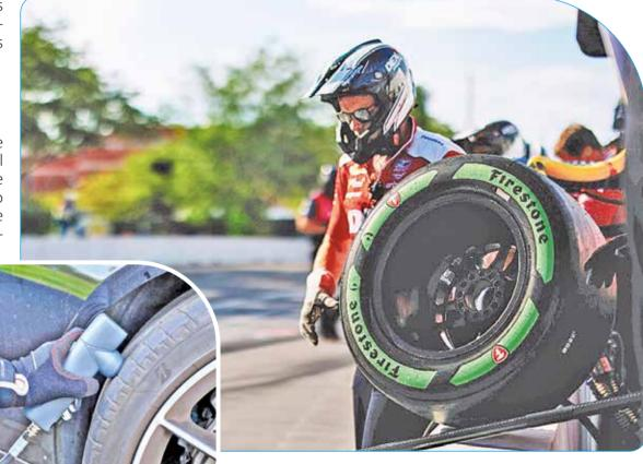
llanta. Estas ranuras, entonces, están diseñadas para mejorar la tracción, evitar el derrape y drenar el agua al conducir sobre superficies mojadas, entre otras funciones.
